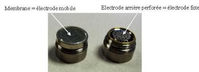
Cette photo représente deux capsules microphoniques électrostatiques. Ici, la membrane du microphone constitue l'électrode mobile du transducteur électrostatique (visible sur la capsule de gauche). Une électrode arrière perforée est visible sur la capsule de droite sont la
