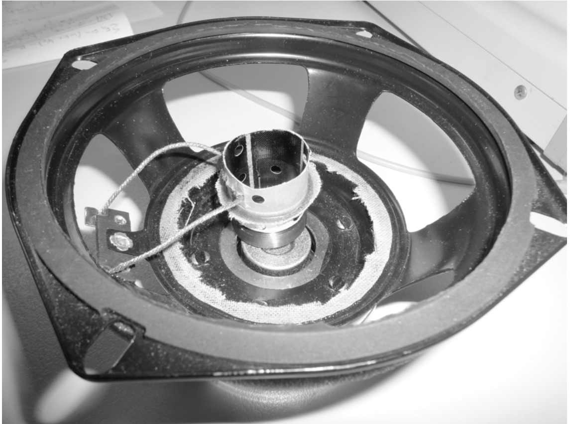
Bobine retirée de l'entrefer du moteur magnétique.
